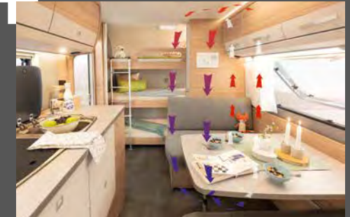
AirPlus – perfekte Luftzirkulation im Innenraum und Hinterlüftung der Dachschränke und Anrichten
