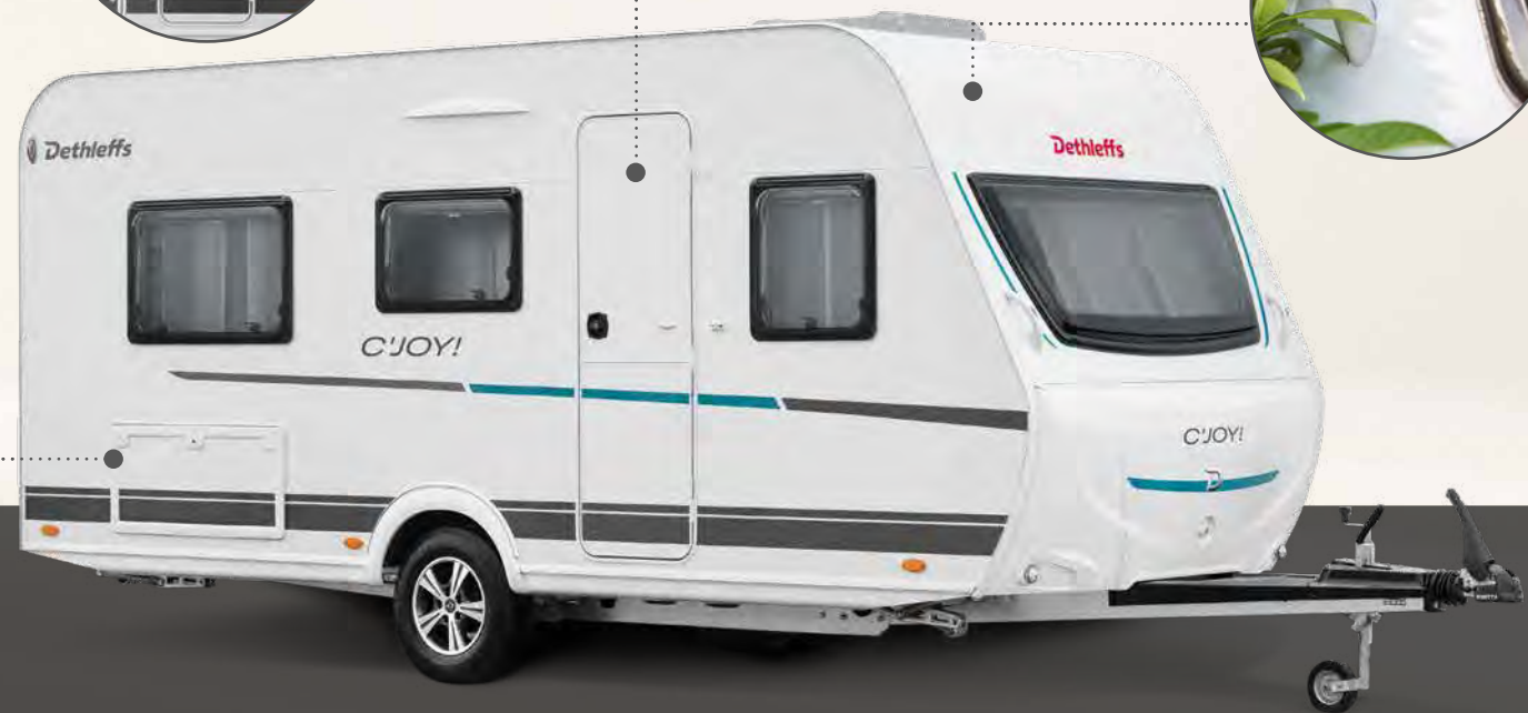
Bug, Dach und Heck aus widerstandsfähigem GFK
