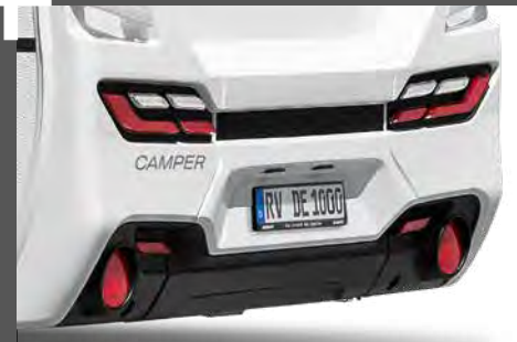
Moderner Heckleuchtenträger mit LED-Leuchten
